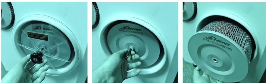
图 5-2: 过滤器清洗图
