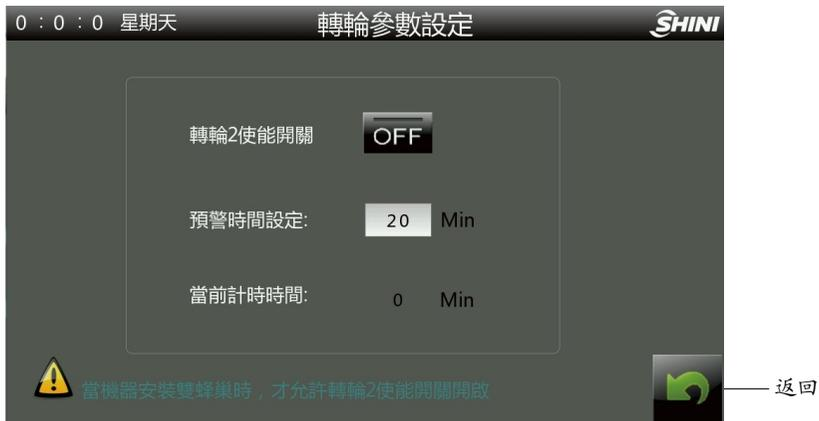
图 4-14: 转轮 2 参数设定画面图(仅适用于 SD 系列机型)
