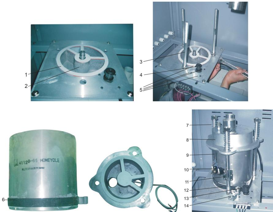
图 5-3：蜂巢转轮安装示意图(SD-40H~700H)
