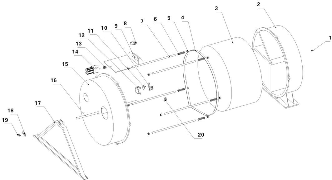
图 5-4: 蜂巢转轮安装示意图(SD-1000H~4000H)
