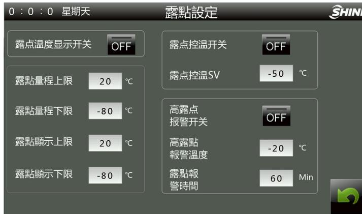
图 4-16: 露点参数设定画面
