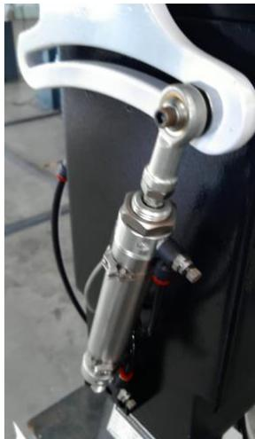
图 2-4: Z 轴气缸固定
