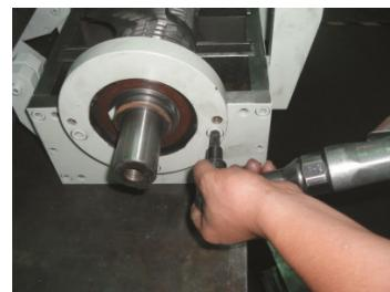
图 6-11: 轴承及刀架安装示意图三
