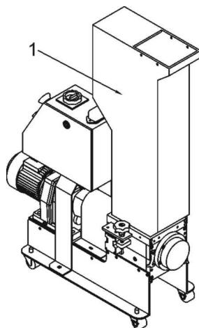
图 6-6: 进料箱、进料口和集料斗的安装示意图一
