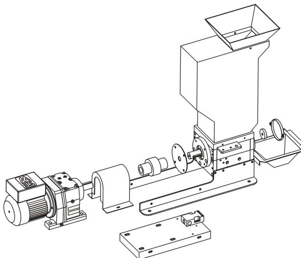
图 6-12：减速机及联轴器的安装
