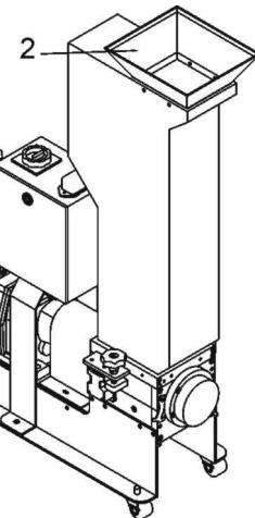
图 6-7：进料箱、进料口和集料斗的安装示意图二
