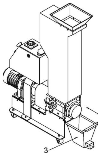
图 6-8：进料箱、进料口和集料斗的安装示意图三
