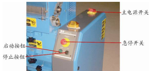
图 4-7: 停止及启动按钮、急停开关
