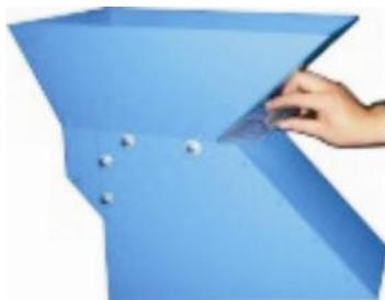
图 3-12: 进料箱、进料口和集料斗的安装示意图三
