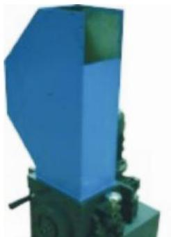
图 3-10: 进料箱、进料口和集料斗的安装示意图一
