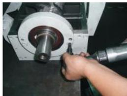
图 3-8: 定刀与动刀的安装示意图二
