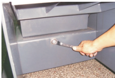
图 6-3: 齿形带的调整图一
