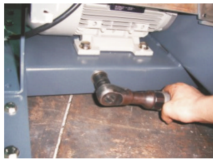
图 6-18: 皮带与皮带轮的安装八
