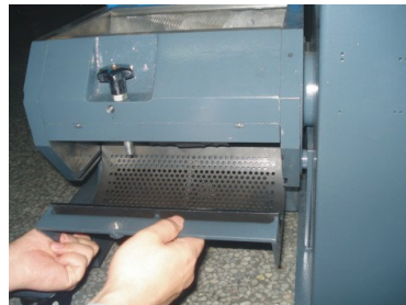
图 4-7: 打开筛网架和筛网图二
