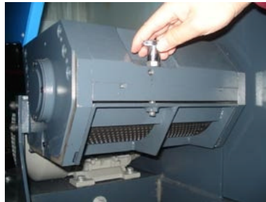
图 4-6: 打开筛网架和筛网图一
