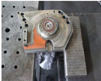
图 6-33: 取出刀架轴步骤一
