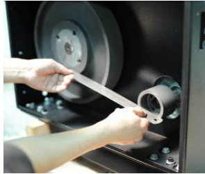
图 6-17: 皮带与皮带轮的安装七
