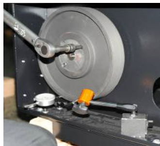
图 6-14: 皮带与皮带轮的安装四
