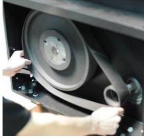
图 6-16: 皮带与皮带轮的安装六
