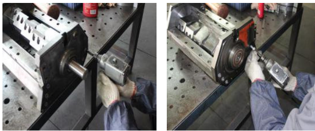
图 6-30: 粉碎室拆散步骤二
