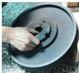
图 6-12: 皮带与皮带轮的安装二
