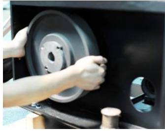
图 6-13: 皮带与皮带轮的安装三
