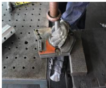
图 6-34: 取出刀架轴步骤二
