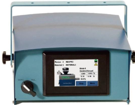
图 2-3:小型称重式喂料机控制器正视图
