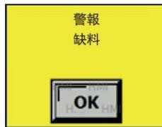
在正常情况下（所需百分比>0），一旦料斗中 MB/AD 的原料重量降至最低至料斗原料最小值以下，如果正压空气填料机正在使用中，则控制器将发出指令开始上料。
