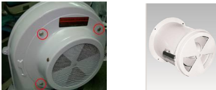
图 3-7: 右: AIF 风机入风口过滤器
