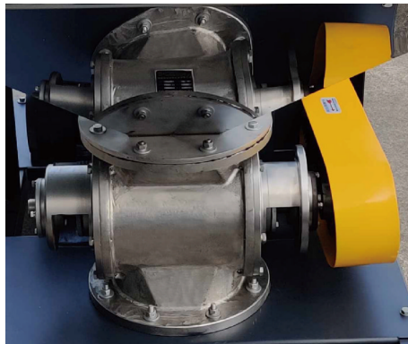
图 2-3: 旋转下料阀装置图
