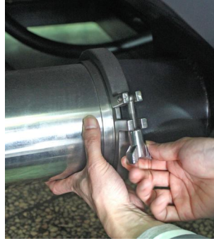
图 4-3: 松开快速管夹图
