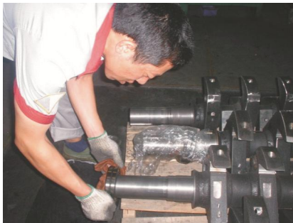
图 6-4: 刀架及轴承的安装
