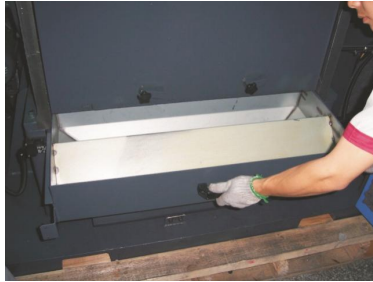
图 6-13: 筛网、网架及集料盒安装五
