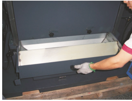
图 6-15: 筛网、网架及集料盒安装五
