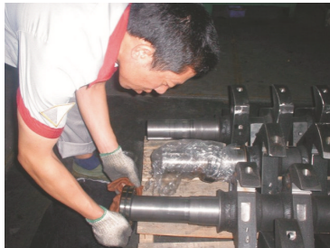
图 6-6：刀架及轴承的安装
