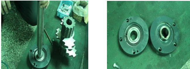
图 6-15: 拆卸左右轴承座步骤三
