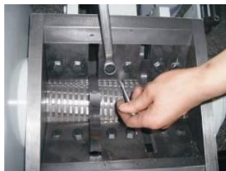
图 6-7: 定刀与齿刀的安装示意图
