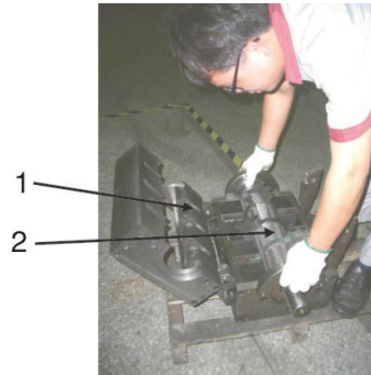
图 6-5: 轴承及刀轴安装示意图二
