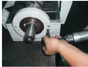
图 6-6: 轴承及刀轴安装示意图三
