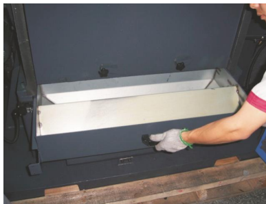
图 6-13: 筛网、网架及集料盒安装五
