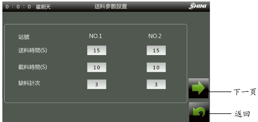
图 4-6: 初级送料参数设置
