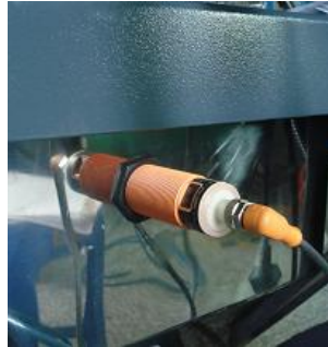
Figure 4-29: Schéma d'interrupteur sur le baril de stockage
