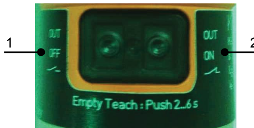
Figure 4-26: Schéma d'ajustement de l'interrupteur de niveau
