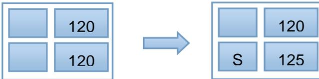
自动模式 2 区温度设定：可通过 或 键随时设定所需温度值，点击 **B** 键进入温度设定模式，此时下排屏幕显示 S 并闪烁，S 后面为设定温度值，再次点击 或 键增加或减少设定温度值；
