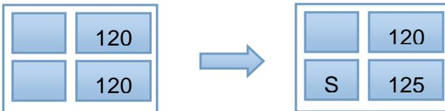
自动模式下 1 区和 2 区温度同时设定，可通过 键或 键随时设定所需温度值，点击 键或 键进入温度设定模式，此时上下排屏幕显示 S，S 后面为设定温度值，再次点击 键或 键同时增加或减少设定温度值；
