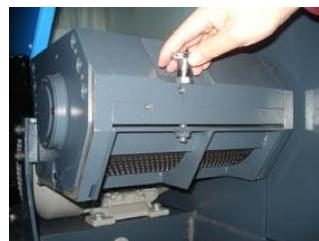
图 4-3: 打开筛网架和筛网图一
