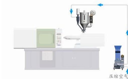
图 2-36: 30 秒立即回收系统 A 型 (高压空气送料)
