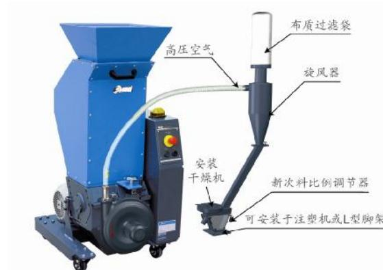
图 2-34: 30 秒立即回收系统安装图五
