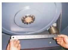
图 3-17: 皮带与皮带轮的安装七
