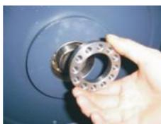
图 3-13: 皮带与皮带轮的安装三
