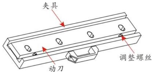
图 4-9: 刀具调节图(SG-20N)
