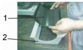
图 3-22：筛网与筛网架的安装一
