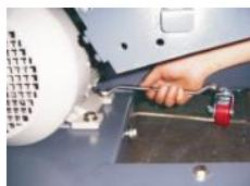
图 3-19: 皮带与皮带轮的安装九
