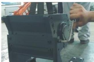
图 3-11: 皮带与皮带轮的安装一
