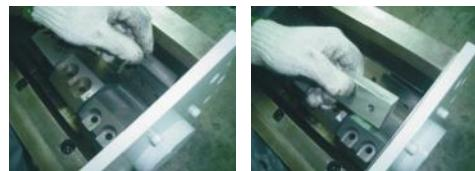
图 3-7: 动刀与定刀的安装一
