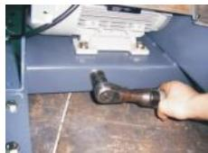
图 3-18: 皮带与皮带轮的安装八
