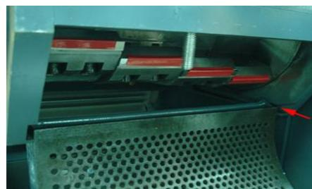
图 3-23：筛网架的安装一
