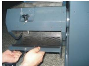
图 4-4: 打开筛网架和筛网图二
