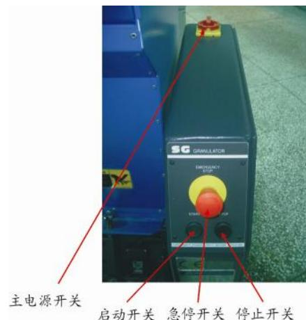
图 4-8: 停止、急停及启动按钮图
