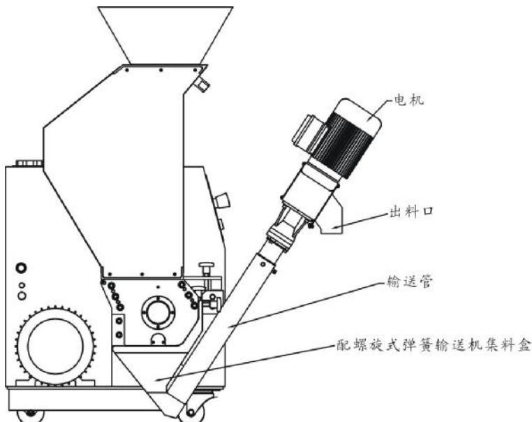
螺旋式弹簧输送机，利用电机带动圆柱形螺旋弹簧产生旋转，把集料盒的粉碎料经过输送管传送到出料口，客户可自备容器从出料口下方收集粉碎料。螺旋式弹簧输送机可不经过拆卸集料盒而收集粉碎料，方便人工集料。
