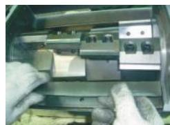
图 3-9: 动刀与定刀的安装三
