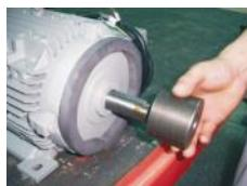
图 3-15: 皮带与皮带轮的安装五
