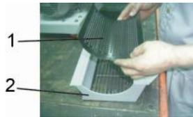
图 3-22: 筛网与筛网架的安装一
