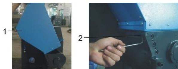
图 3-20: 进料箱、进料口和集料斗的安装示意图一
