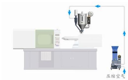
图 2-36: 30 秒立即回收系统 A 型 (高压空气送料)
