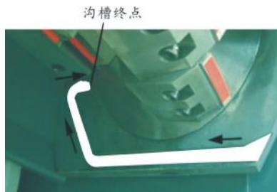
图 3-24: 筛网架的安装二
