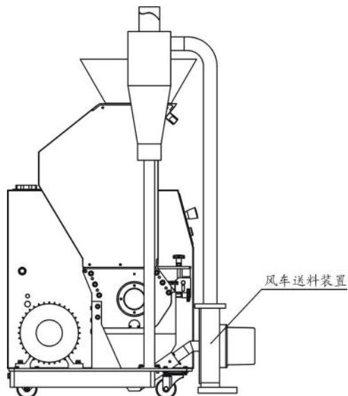
图 2-38: 风车+旋风器送料装置
