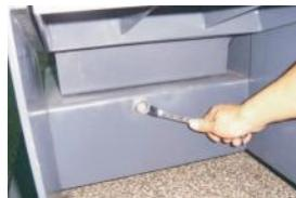
图 6-5: 齿形带的调整图一
