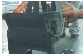
图 3-11：皮带与皮带轮的安装一
