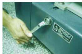
图 6-6: 齿形带的调整图二
