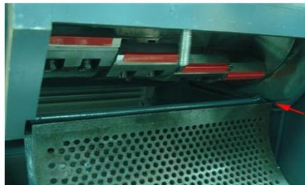
图 3-23: 筛网架的安装一
