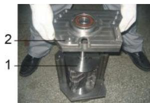
图 3-5: 轴承及刀架安装示意图三
