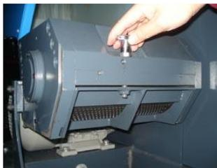
图 4-3: 打开筛网架和筛网图一
