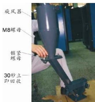
图 2-32: 30 秒立即回收系统安装图三
