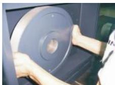
图 3-12: 皮带与皮带轮的安装二
