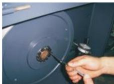
图 3-14: 皮带与皮带轮的安装四
