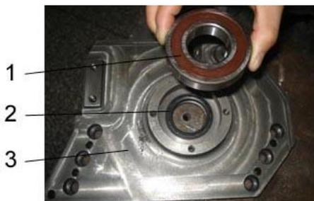
图 3-3: 轴承及刀架安装示意图一
