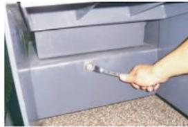
图 6-5: 齿形带的调整图一
