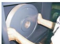
图 3-12：皮带与皮带轮的安装二
