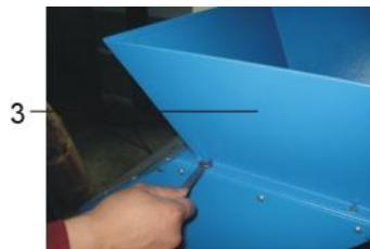
图 3-21：进料箱、进料口和集料斗的安装示意图二
