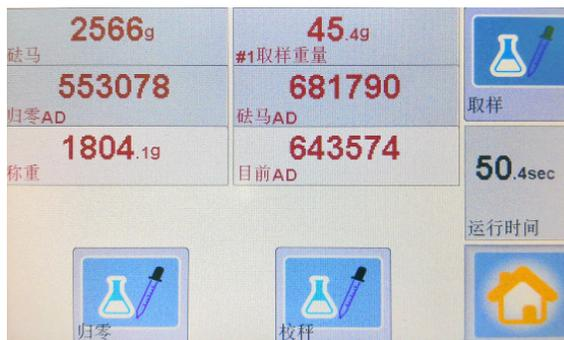
校秤：如果是进入此画面进行首次或再次校秤的话，先将料斗内余料清除，输入砝码重量保持料斗盖打开或关闭状态，等待 15 秒秤稳定时间后按下归零键，将砝码放入桶内等待 15 秒稳定后按下校秤键。
