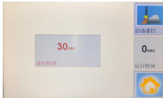
按下清扫时间可以弹出的窗口中更改清扫的时间，按下启动清扫键将会按所设定时间运转，将螺杆内余料转出。
