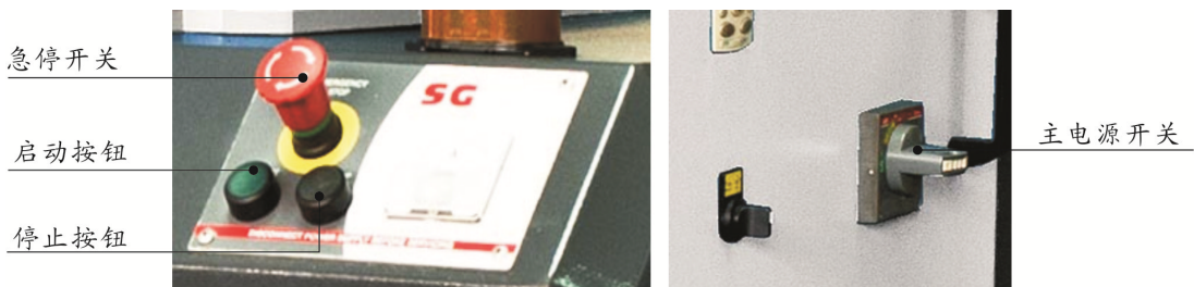
图 2-2：停止及启动按钮、急停开关
