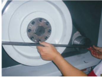
图 3-7：皮带轮及电机的安装四
