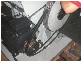
图 3-6：皮带轮及电机的安装三
