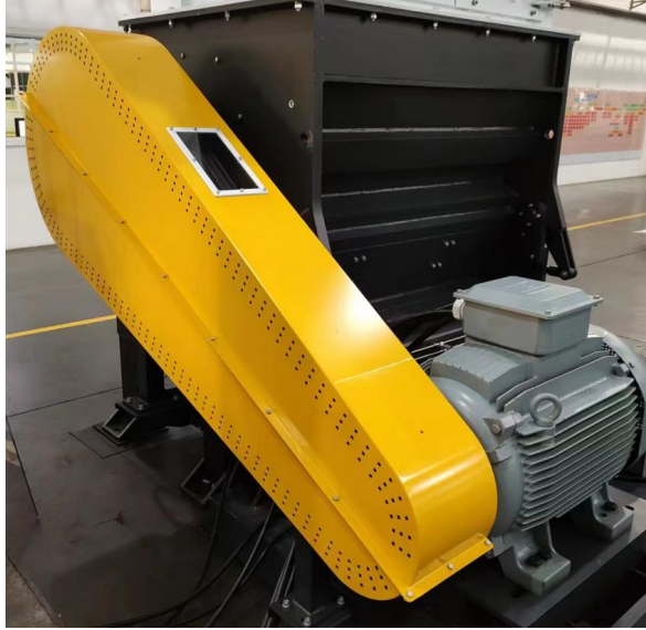
图 6-8: 皮带轮及电机的安装三
