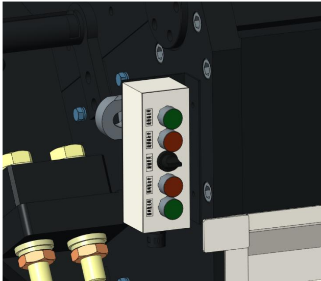
图 4-3: 液压站启动按钮及液压缸按钮
