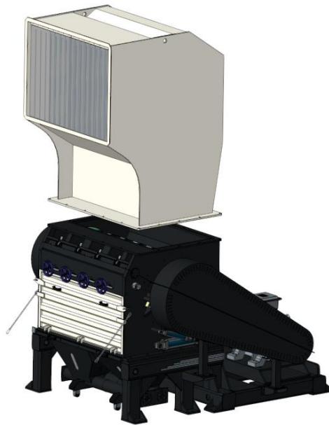
图 3-4: 安装粉碎机主体及进料箱步骤二
