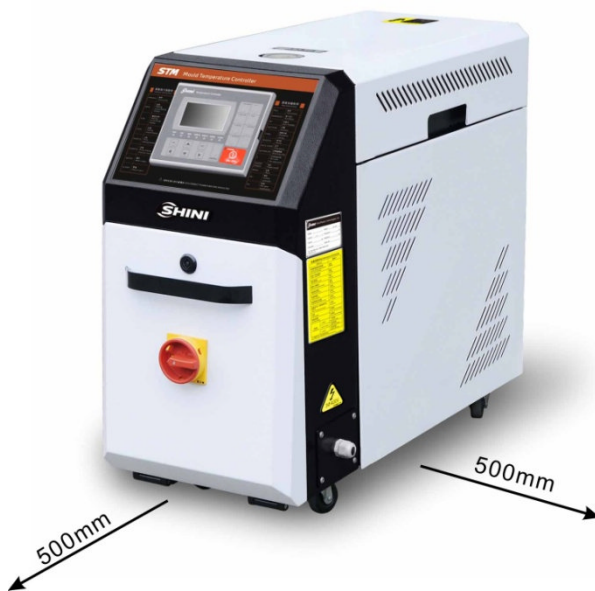
图 3-1: 机器安装位置图
