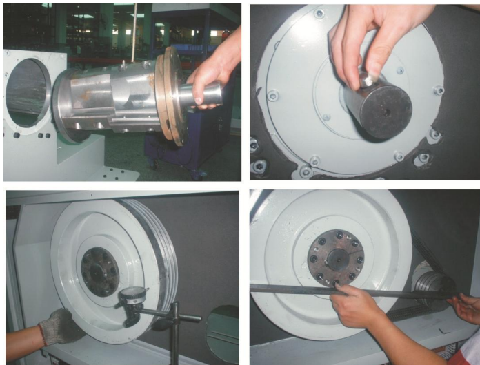
图 6-14: 轴承、电机、带轮及皮带安装
