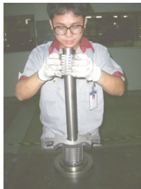
图 3-7: 定刀与动刀的安装示意图一
