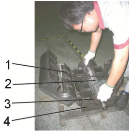
图 3-4：轴承及刀架安装示意图三
