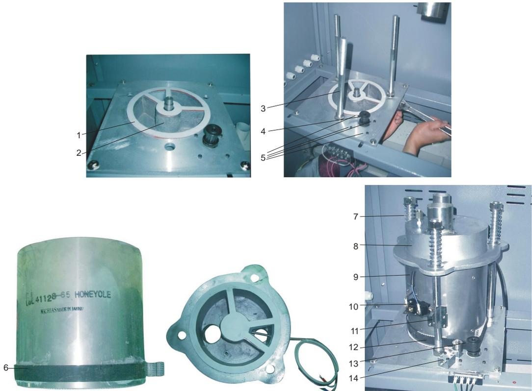
图 6-7: 蜂巢转轮安装示意图
