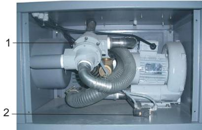
图 6-4: 吸料风机安装图
