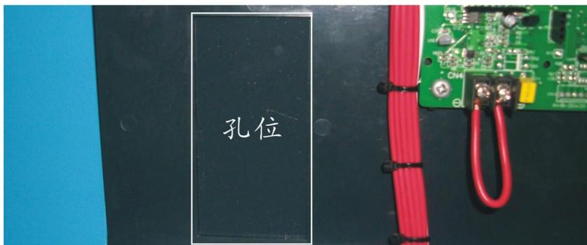
图 6-9: 露点计安装孔位
