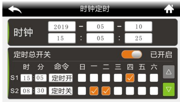
图 4-8: 设置定时开关机画面
