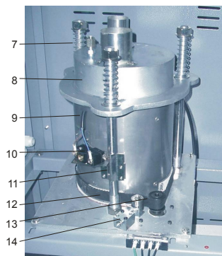
图 6-5: 蜂巢转轮安装步骤四
