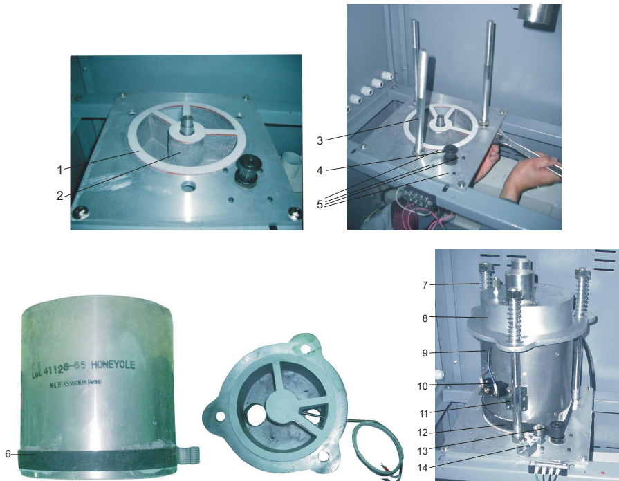
图 6-3: 蜂巢转轮安装示意图(SD-40H~700H)
