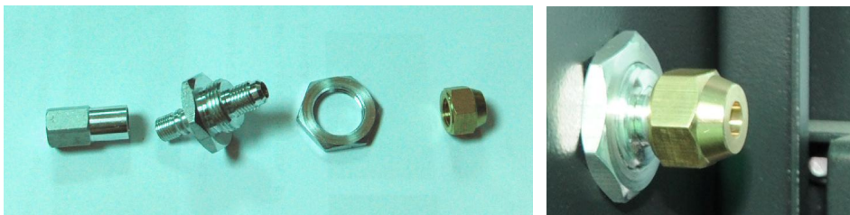
图 6-9: 原有机台的铜接头组件
