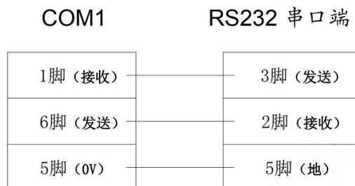
图 7-2: COM1 端口与 RS232 串口端连接示意图
