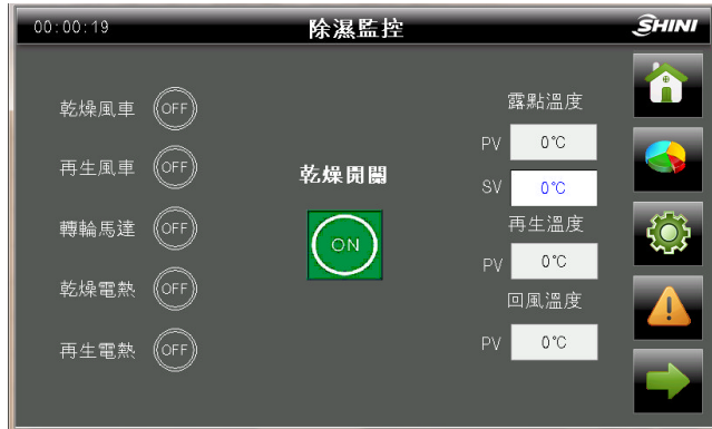
图 4-15: 除湿监控画面
