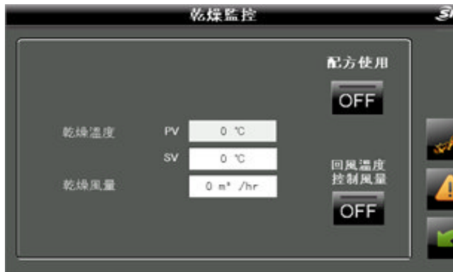
图 4-16: 除湿监控画面
