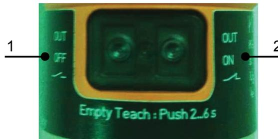
Figura 2-26: Diagrama del ajuste del interruptor del nivel de materiales
