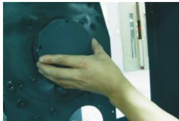
图 3-7: 轴承盖板安装示意图
