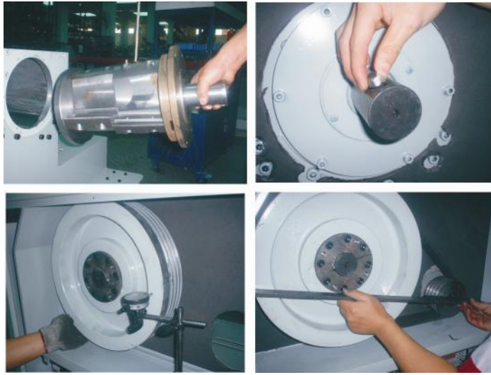
图 3-8: 轴承、电机、带轮及皮带安装
