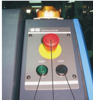
启动按钮 急停开关 停止按钮 图 4-5: 停止及启动按钮、急停开关
