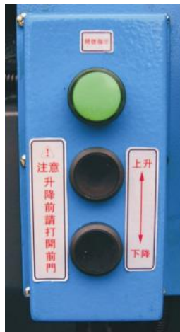
图 4-3: 电动推杆 操作按钮
