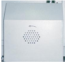
图 3-17: 检查风机的运转方向
