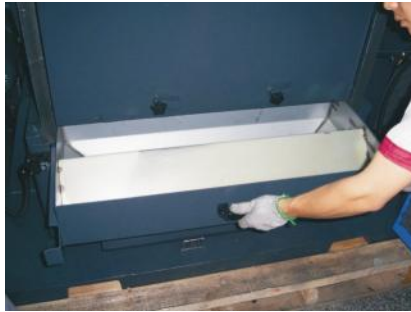
图 3-14: 筛网、网架及集料盒安装五
