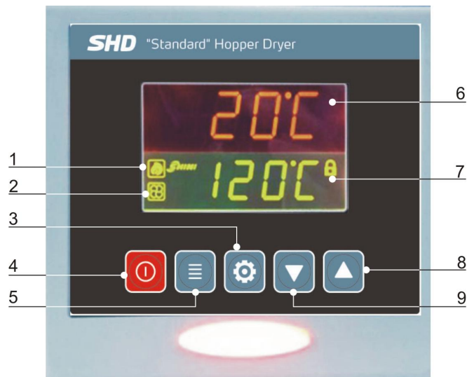
Figura 1-1: Panel de Control
