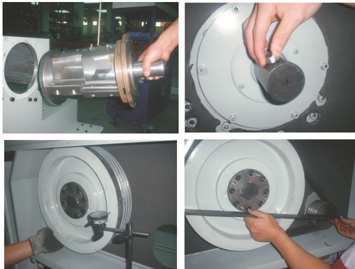
图 3-7：轴承、电机、带轮及皮带安装
