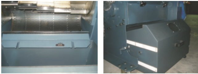
图 3-8: 筛网、网架及集料盒安装
