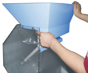
图 3-13: 进料箱、进料口和集料斗的安装示意图三
