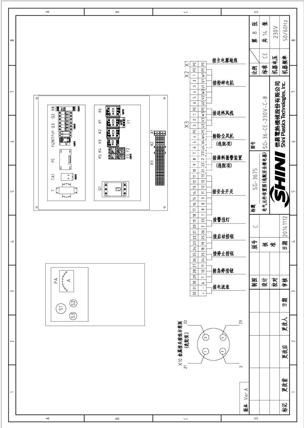
图 2-30: 电气元件布置图(选配安全继电器) (SG-3675 230V)
