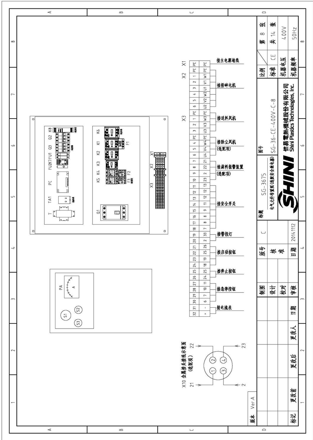
图 2-23: 电气元件布置图(选配安全继电器) (SG-3675 400V)
