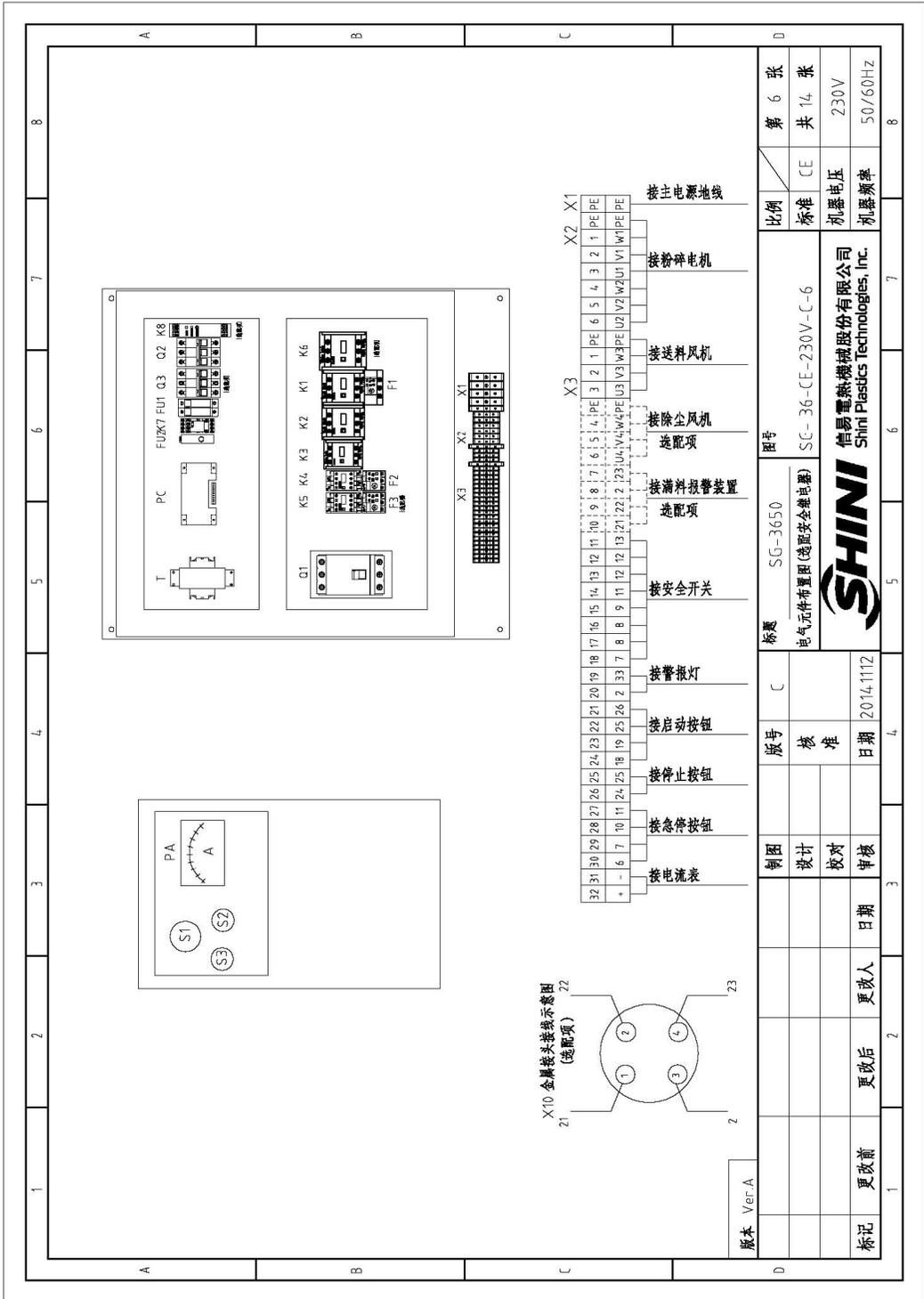
图 2-28: 电气元件布置图(选配安全继电器) (SG-3650 230V)
