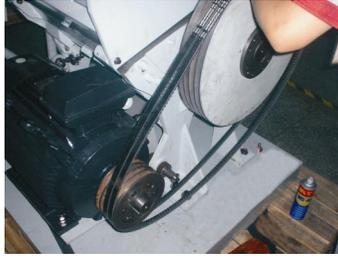
图 3-13: 皮带轮及电机的安装(SG-3675)三
