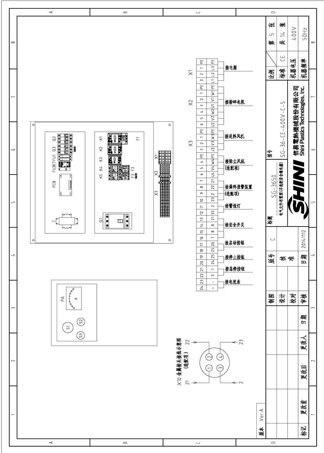
图 2-20: 电气元件布置图(不选配安全继电器) (SG-3650 400V)
