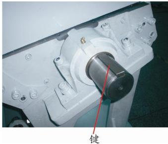
图 3-11: 皮带轮及电机的安装(SG-3675)一
