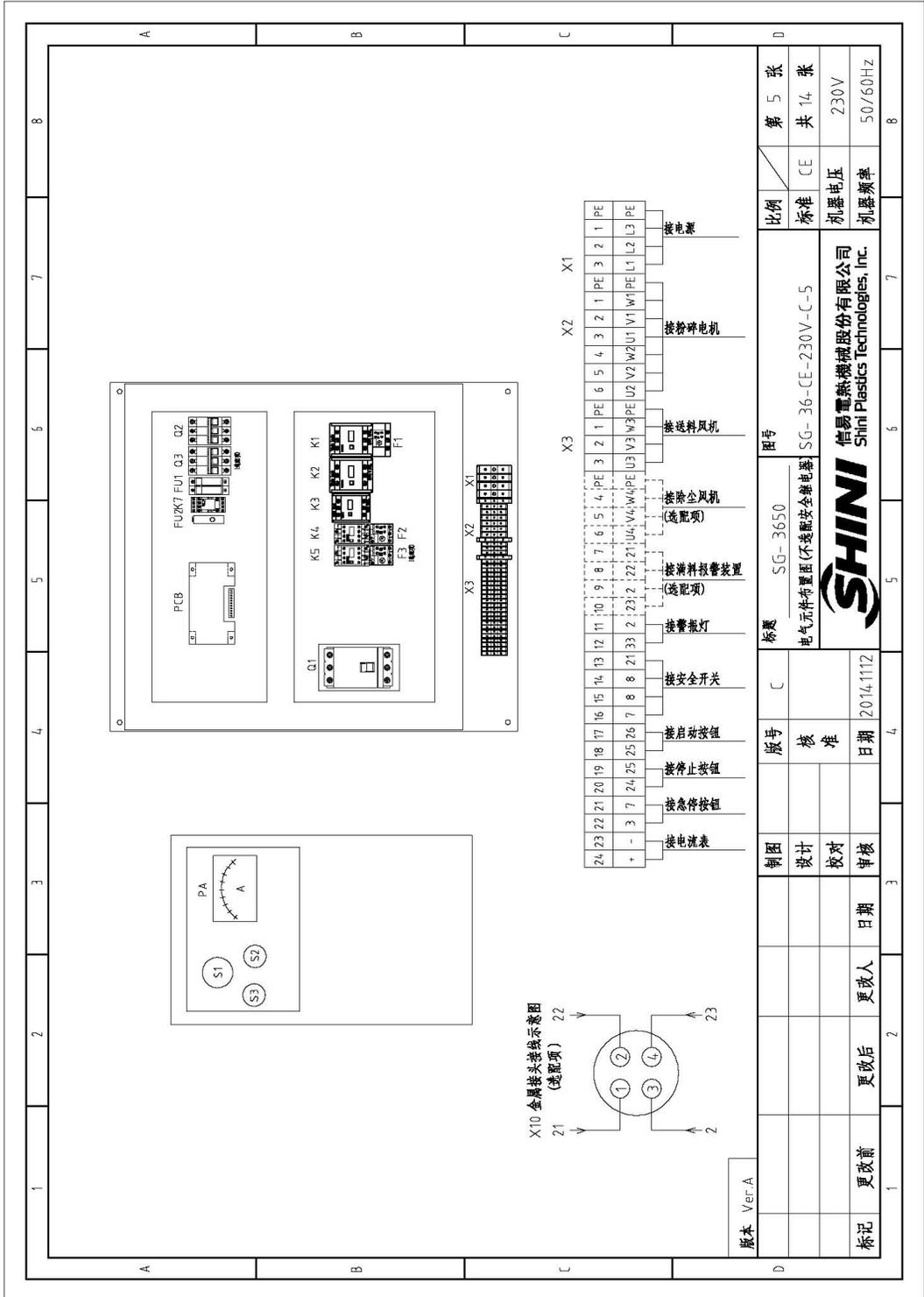
图 2-27: 电气元件布置图(不选配安全继电器) (SG-3650 230V)
