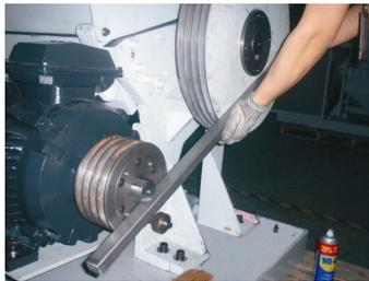
图 3-9: 皮带轮及电机的安装(SG-3650)四
