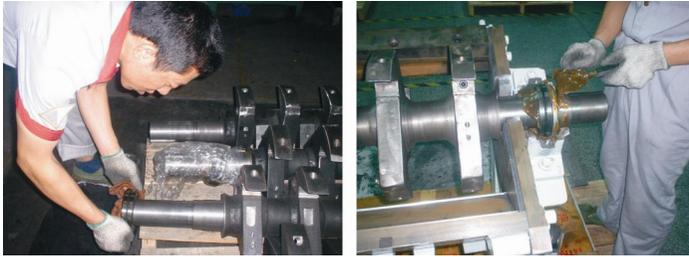
图 3-5: 刀架轴安装示意图
