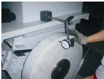
图 3-12: 皮带轮及电机的安装(SG-3675)二
