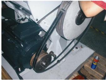
图 3-8: 皮带轮及电机的安装(SG-3650)三
