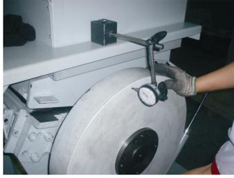
图 3-7: 皮带轮及电机的安装(SG-3650)二
