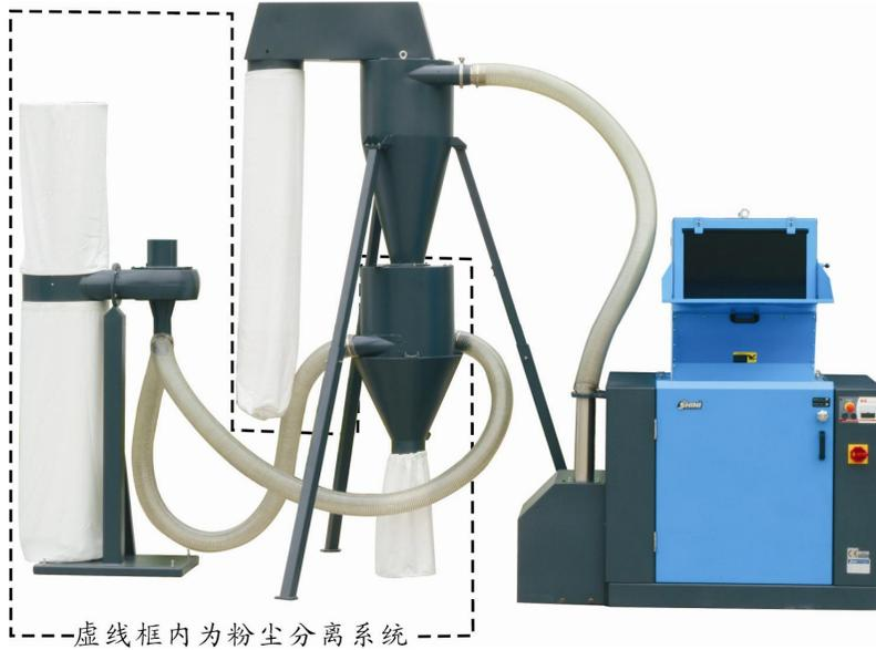
图 2-33: 粉尘分离系统安装示意图
