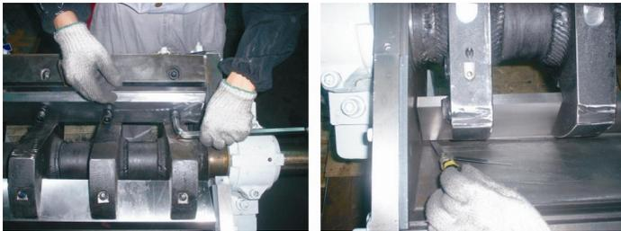
图 3-16: 定刀与动刀的安装
