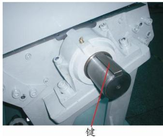
图 3-6: 皮带轮及电机的安装(SG-3650)一
