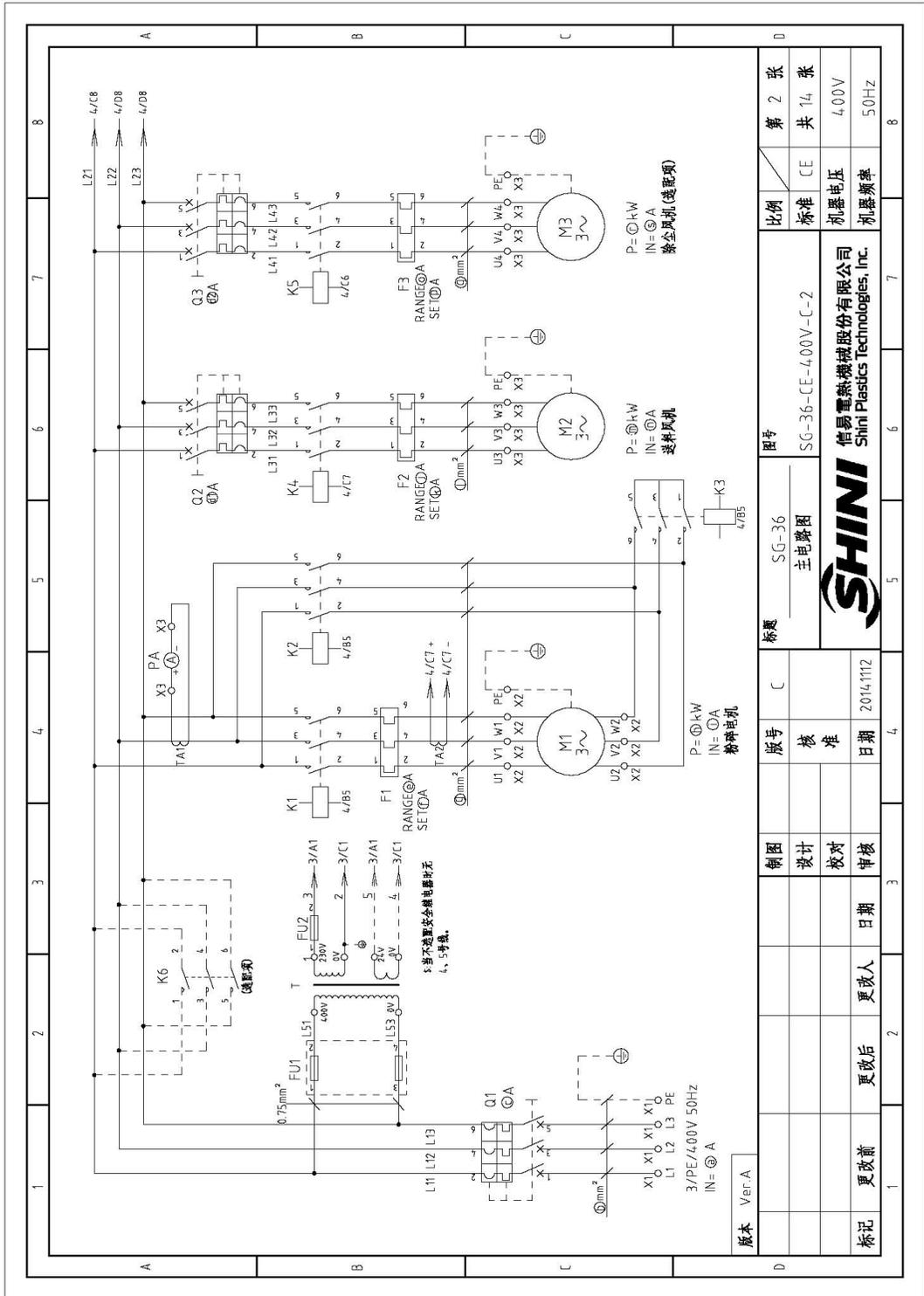
图 2-17: 主电路图(400V)
