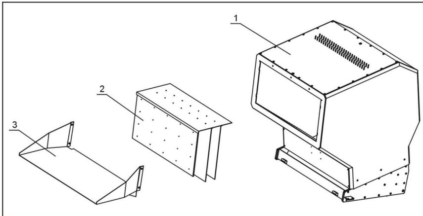
图 2-14: 进料箱, 隔音箱及挡板
