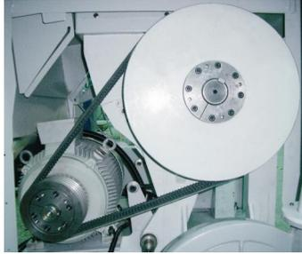
图 3-10: 皮带轮及电机的安装(SG-3650)五
