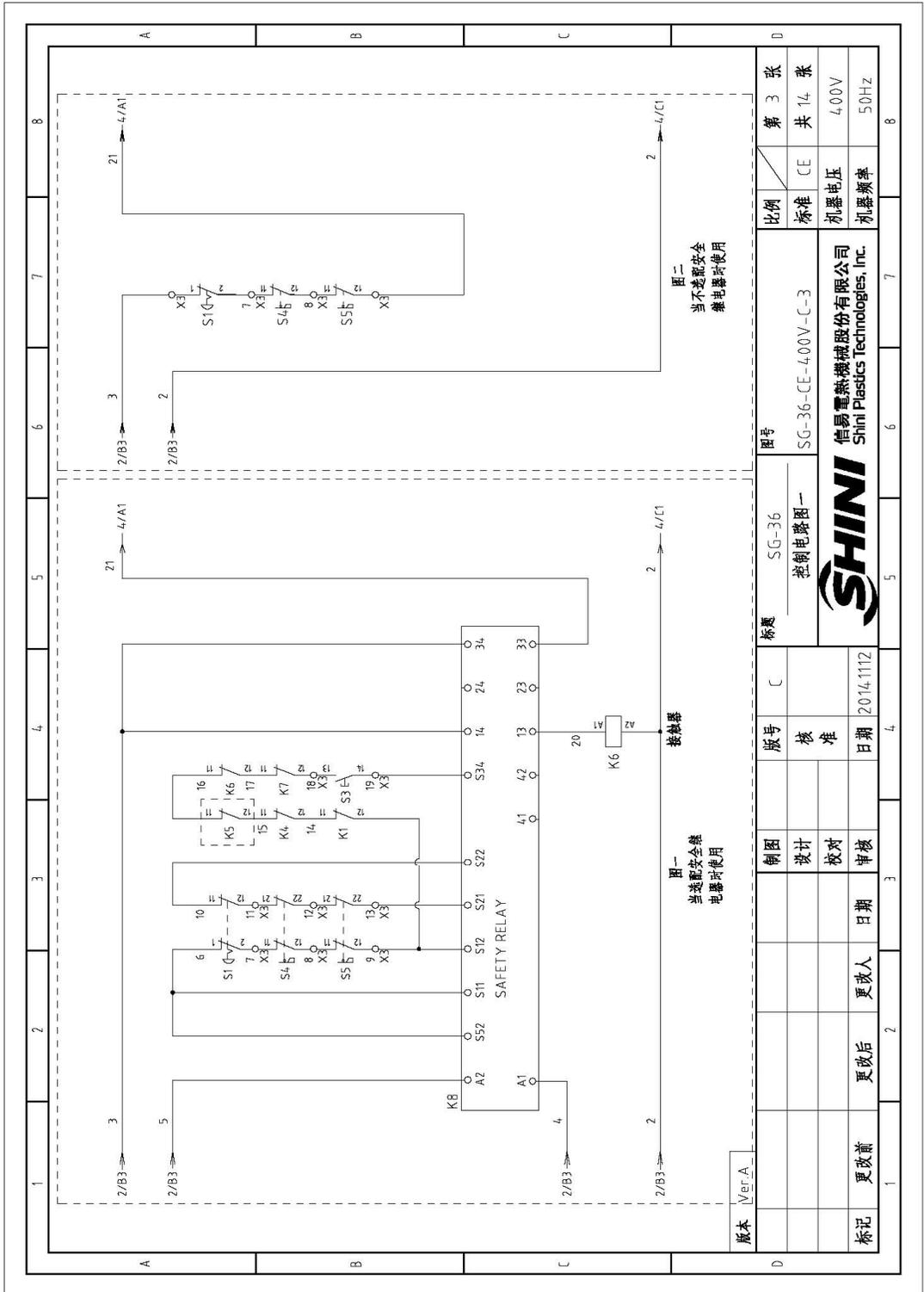
图 2-18: 控制电路图 1(400V)
