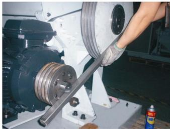
图 3-15: 皮带轮及电机的安装(SG-3675)五
