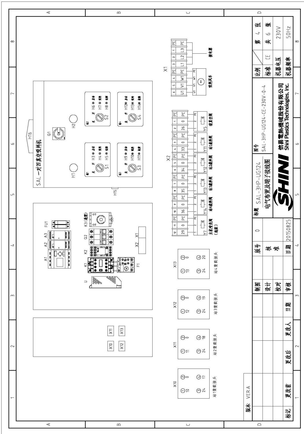
图 2-29: 电气布置及端子接线图(SAL-3HP-UG124 230V)
