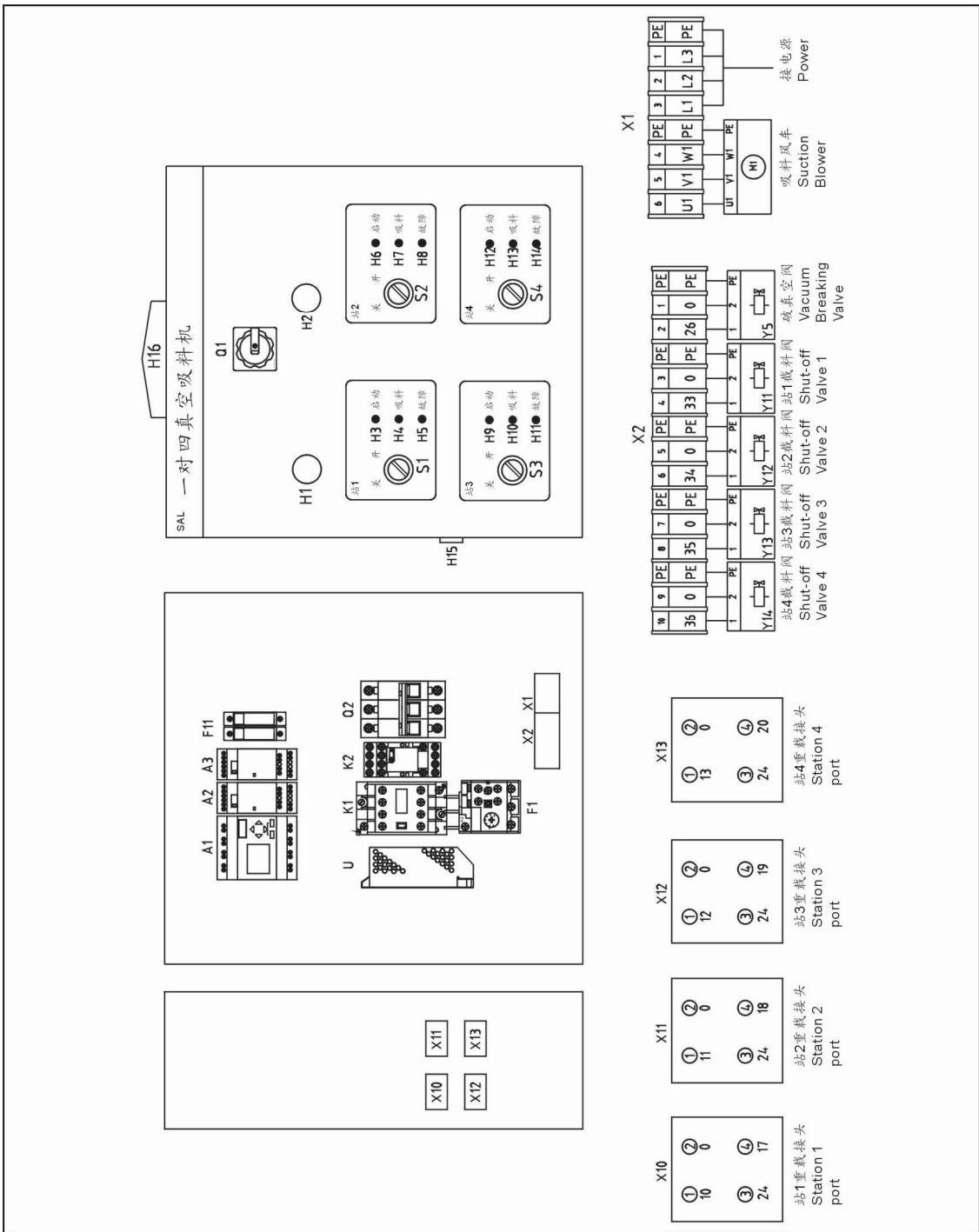
图 2-25: 电气布置及端子接线图(SAL-2HP/5HP/10HP-UG124 230V)
