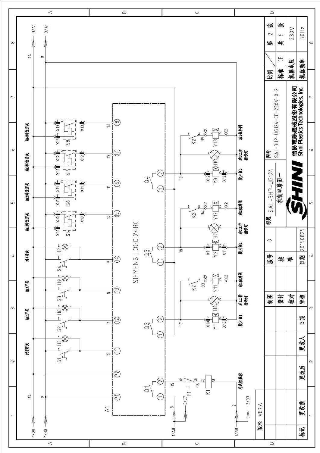
图 2-27: 控制电路图一(SAL-3HP-UG124 230V)
