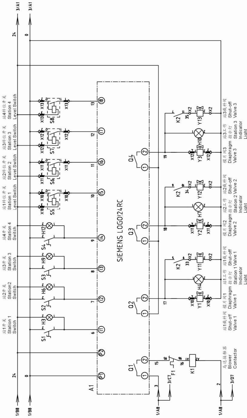
图 2-23: 控制电路图一(SAL-2HP/5HP/10HP-UG124 230V)
