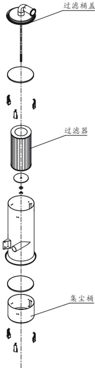
1. 打开过滤桶盖，取出过滤器，采用高压气枪从过滤器里面往外面吹掉其上面的灰尘。
