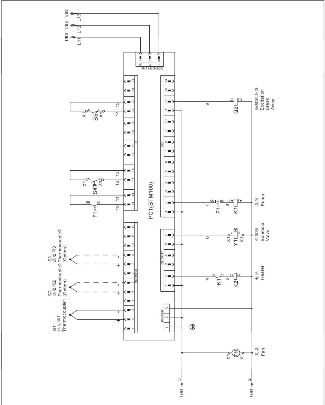
图 2-26: 控制电路图(STM-607~1220) (230V)
