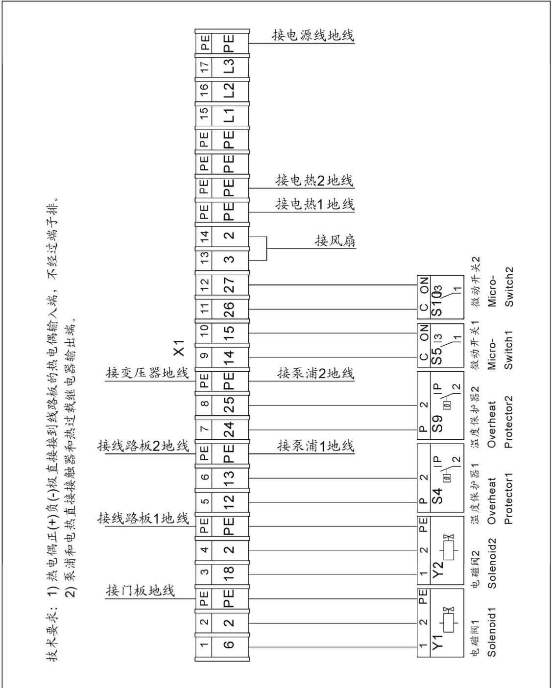
图 2-24: 端子接线图(STM-607/910-D) (230V)
