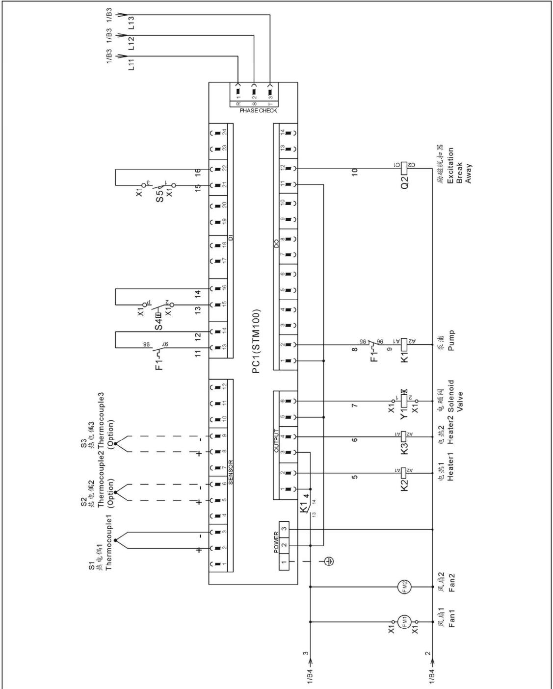
图 2-29: 控制电路图(STM-2440) (230V)
