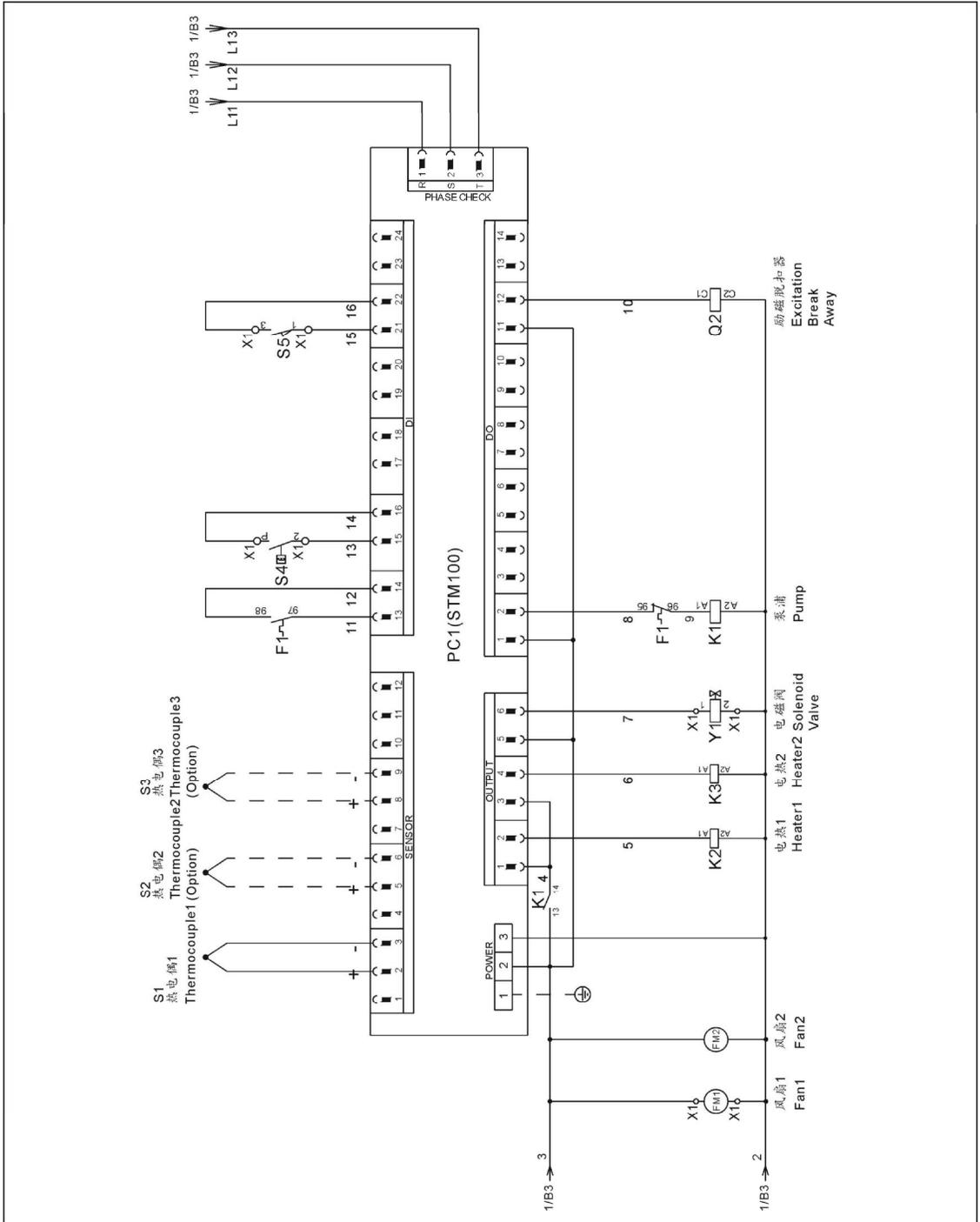
图 2-15: 控制电路图(STM-2440) (400V)
