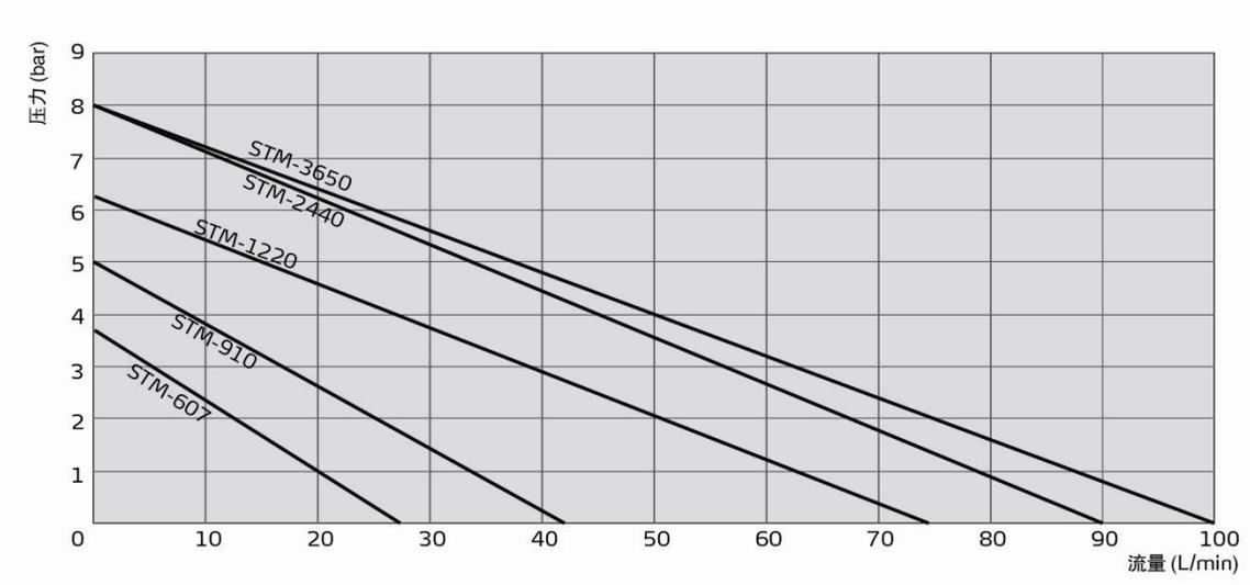
图 1-1: 泵浦曲线图
