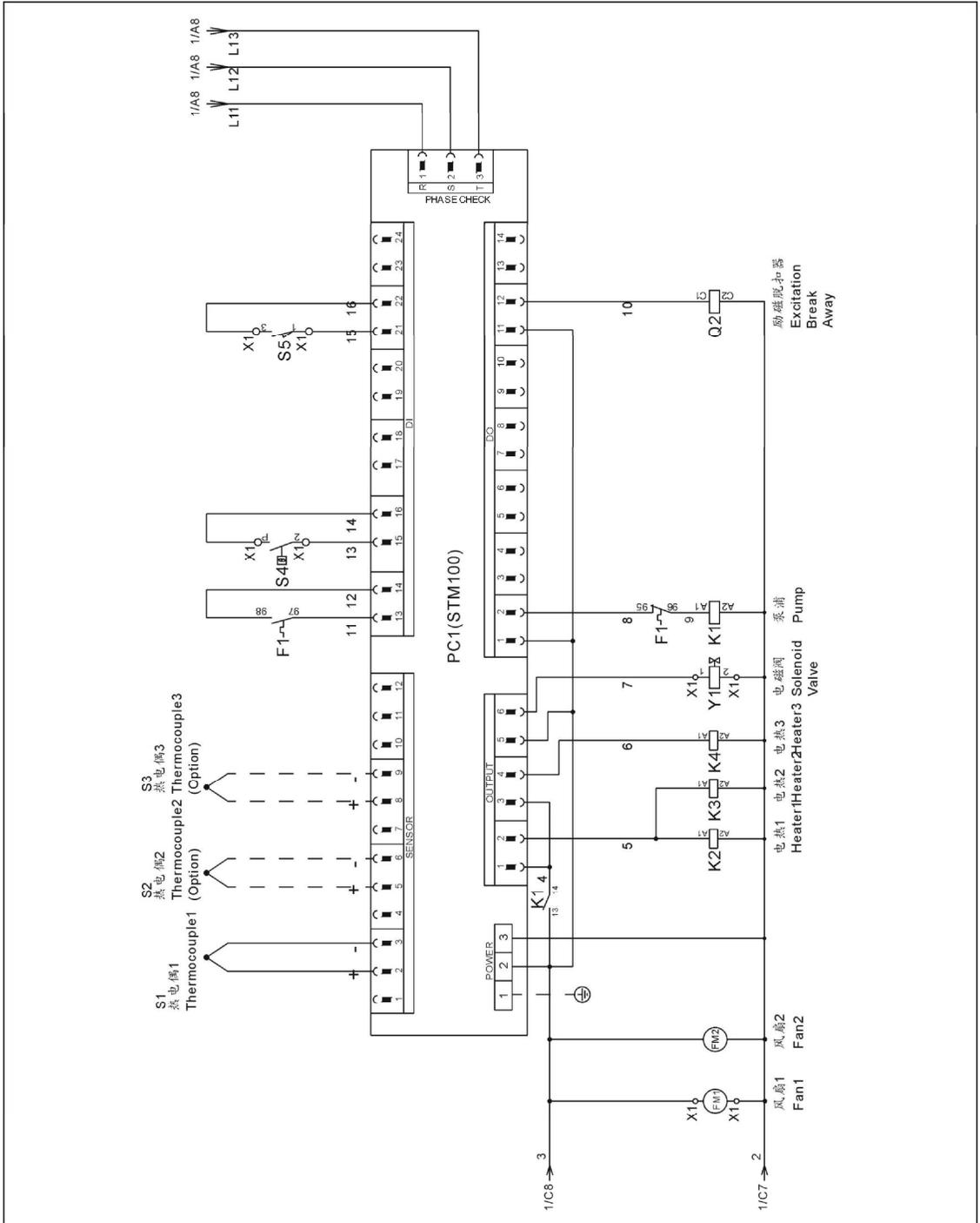
图 2-18: 控制电路图(STM-3650) (400V)
