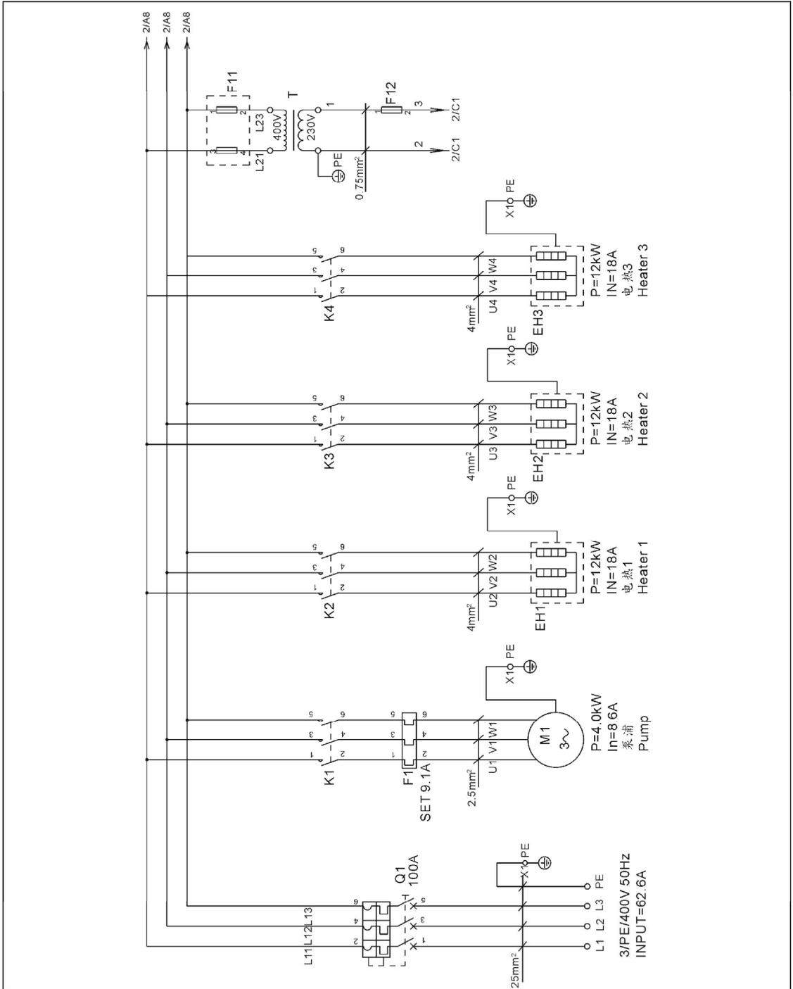
图 2-17: 电路图(STM-3650) (400V)
