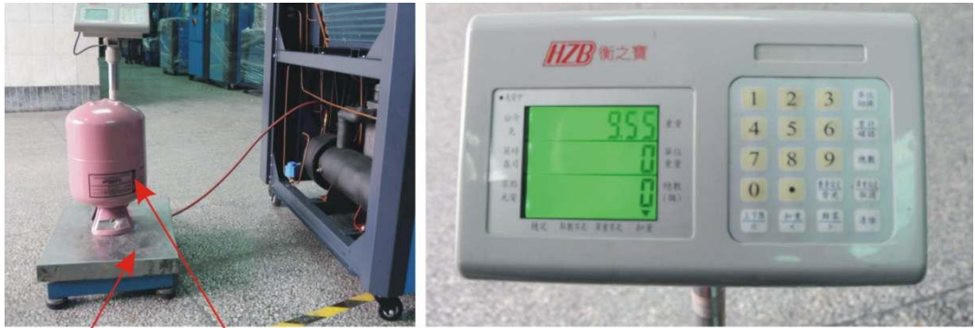
电子秤 冷媒罐
