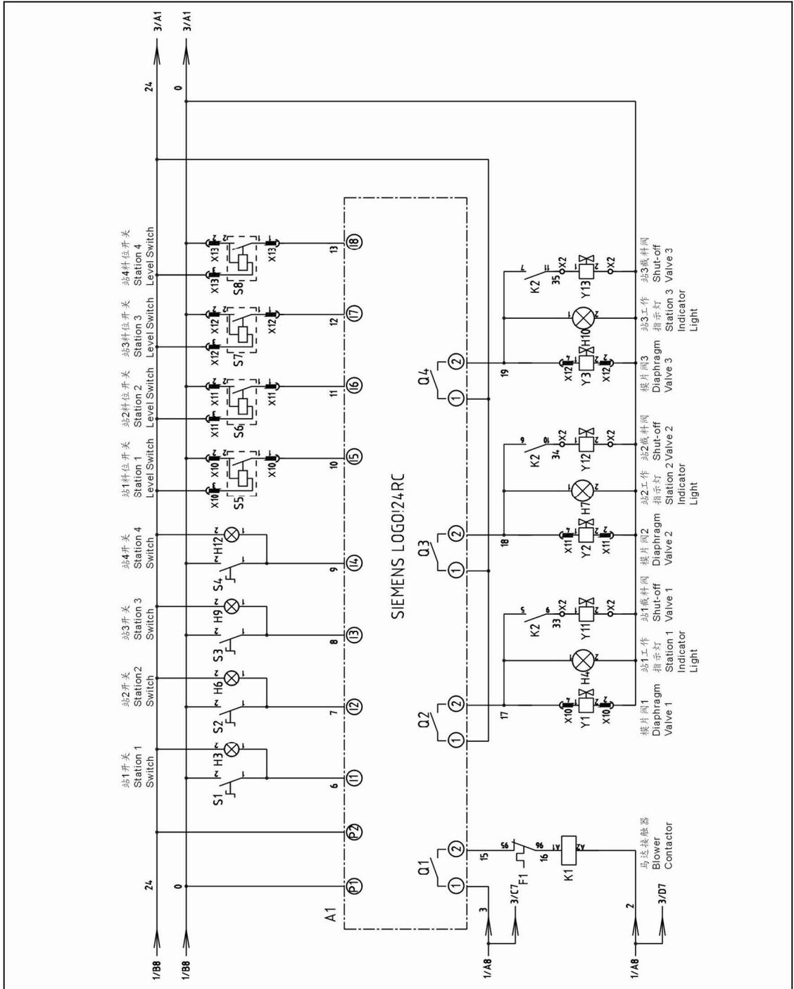
图 2-15: 控制电路图一(SAL-2HP/5HP/10HP-UG124 400V)
