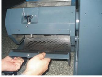
图 4-4：打开筛网架和筛网图二
