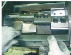
图 3-6：动刀与定刀的安装三
