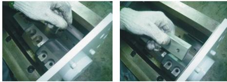
图 3-4：动刀与定刀的安装一
