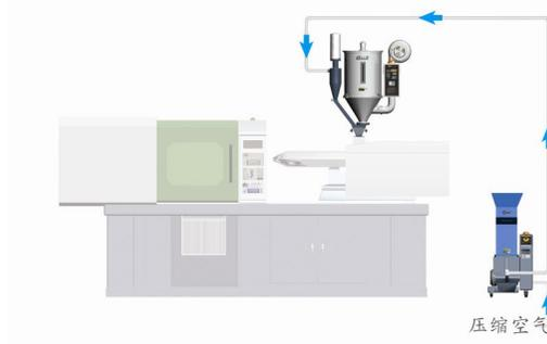
图 2-27: 30 秒立即回收系统 A 型 (高压空气送料)
