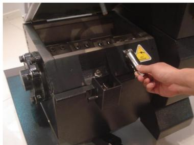
图 3-29：集料盒的安装示意图四
