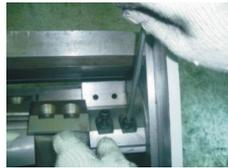
图 3-5：动刀与定刀的安装二
