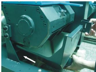
图 3-26: 集料盒的安装示意图一
