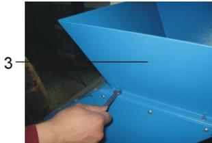
图 3-9: 进料箱部件的安装示意图二
