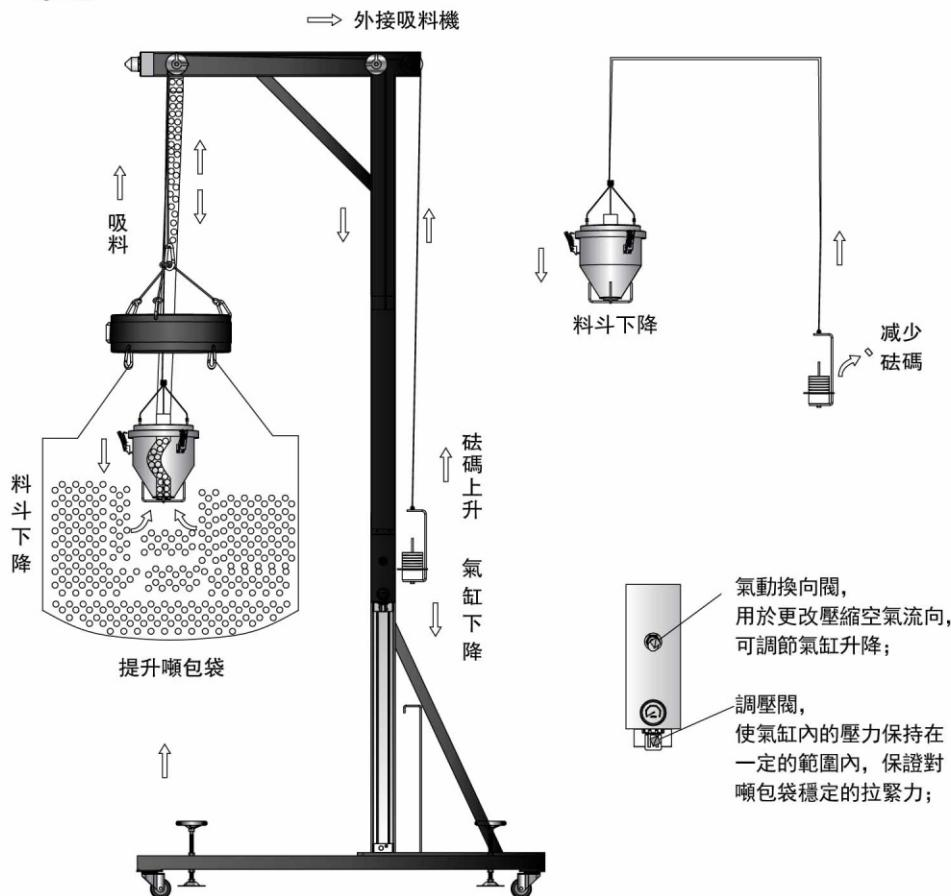
打開氣動換向閥控制氣缸上升，使起吊裝置下降到可以固定噸包袋的高度；完成固定噸包袋，使用氣動換向閥控制氣缸下降，起吊裝置達到拉緊噸包袋的作用；用減少磅碼的方法使吸料裝置下降到噸包袋內進行吸料；隨著吸料的進行，噸包袋的重量會逐漸減輕，直到小於氣缸的拉緊力，整個噸包袋會被拉起，使得底部的料也被吸空，同時氣缸到達行程，觸發感應器，報警燈亮，吸料結束；
