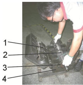
图 6-3: 轴承及刀架安装示意图三
