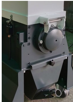
图 6-8: 进料箱、进料口和集料斗的安装示意图
