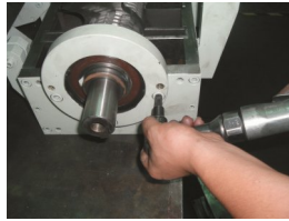
图 6-13: 定刀与动刀的安装示意图二
