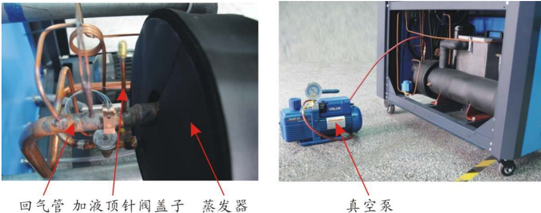
图 5-1: 填充冷媒一
