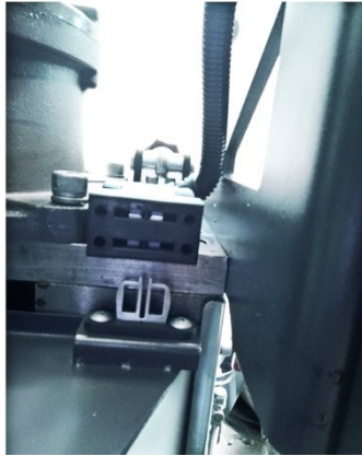
图 5-4: 集料盒安全开关插销（机器选装 CE 标准才具有）
