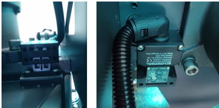
图 3-6: 集料盒安全位置开关（机器选装 CE 标准才具有）
